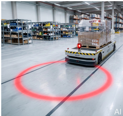
警示区域可调节 角度可调节支架, 通过调节支架缩放警示区域
